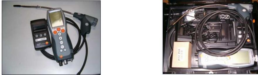
*Figura 3: aparatos de medidas de combustión*
