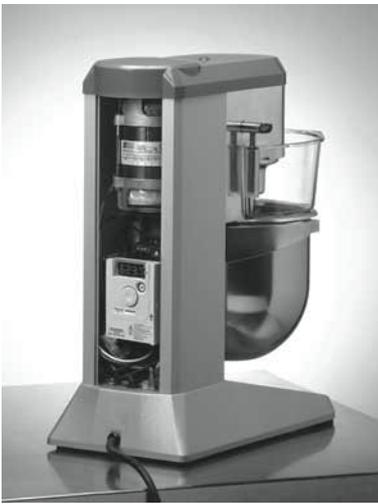
ATV 12 para control de un mezclador
