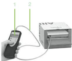
Configuración del variador en su embalaje con la herramienta "Multi-Loader" **VW3-A8121** + conjunto de cables VW3 A8 126
