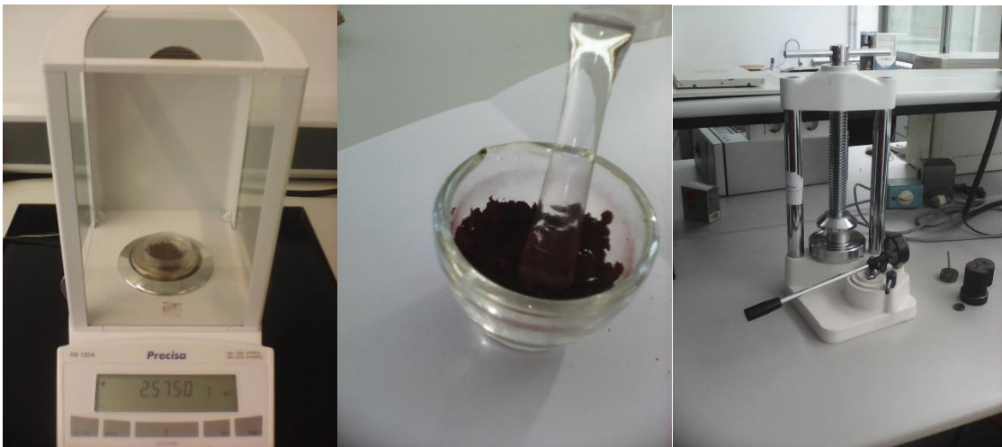
Figura 17. Material empleado en la fabricación de las ferritas. Balanza de precisión, mortero, troquel.
