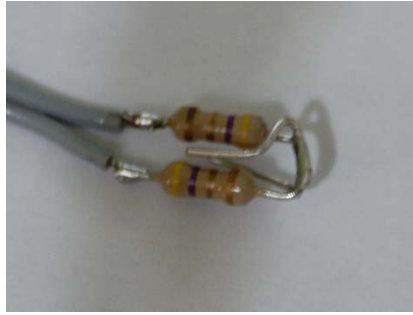
Figura 5.10.- Sistema de calefacción del calorímetro.
