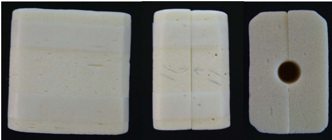
Figura 5.8.- Sistema de aislamiento: alzado (izquierda), perfil (centro) y planta (derecha).
