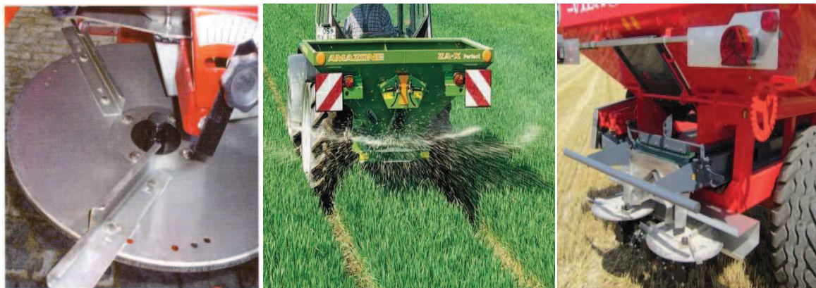
Figura 8. Abonadoras de proyección y componentes.
