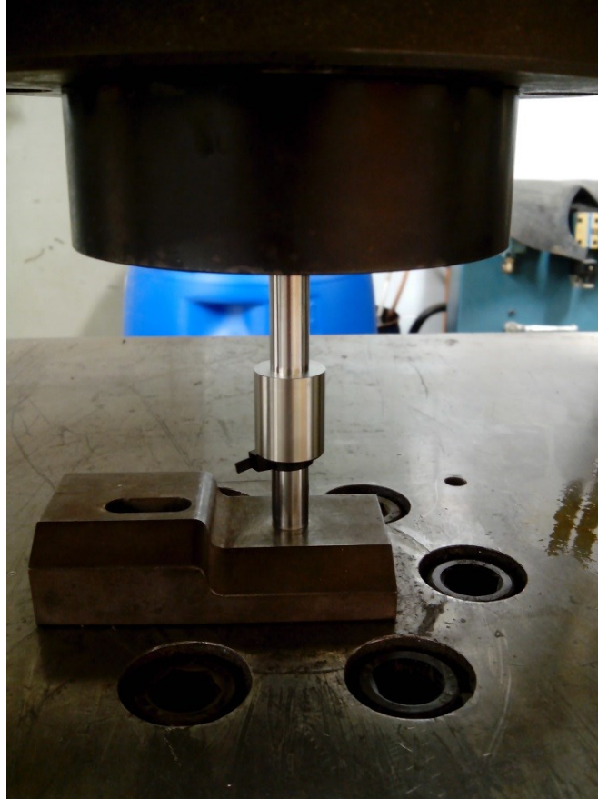
Ilustración 4—1. Montaje para compactación de polvos metálicos de la escuela politécnica de la Uva.
