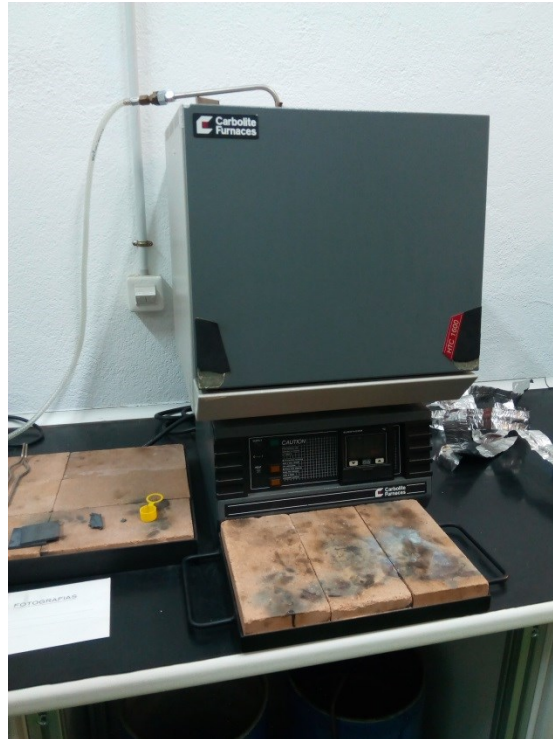
Ilustración 4–3. Horno para los tratamientos térmicos de la EII de la UVa, departamento de ciencia de los materiales.
