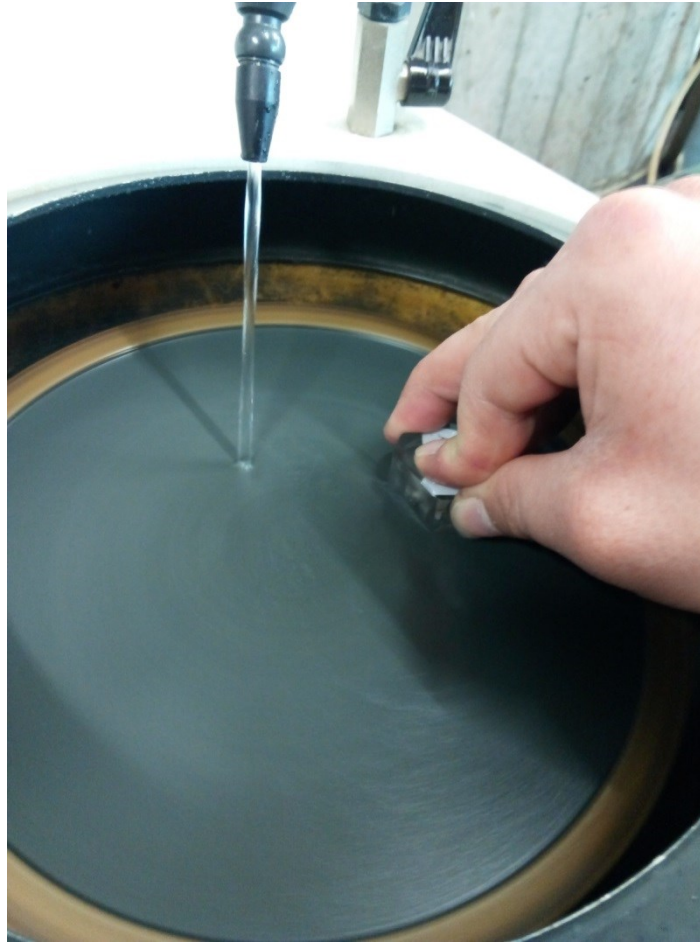
Ilustración 4–5. Proceso de desbaste, observamos la mesa, al fuente de agua y una probeta sujeta intentando ejercer presión en el centro de la misma.
