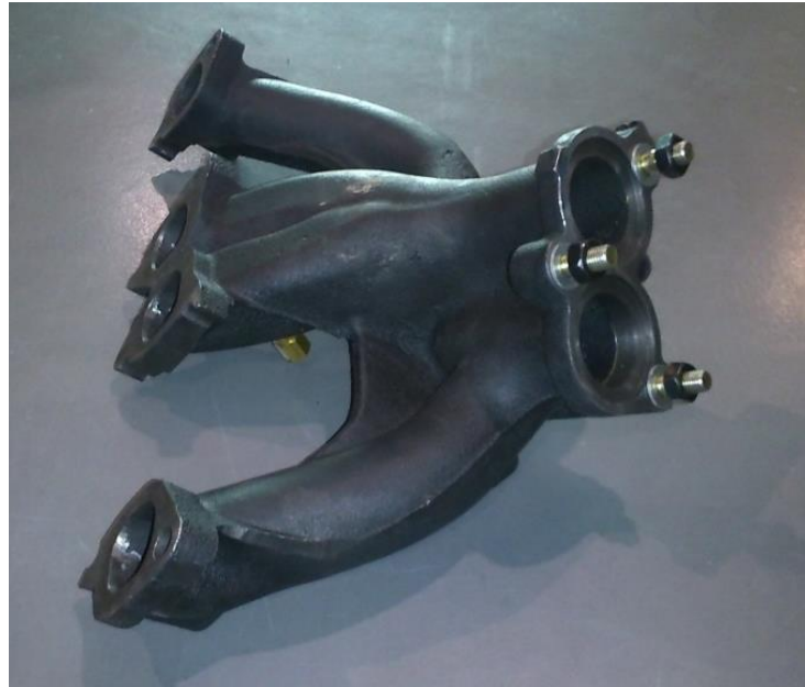
Figura2.16.- Colector de escape
