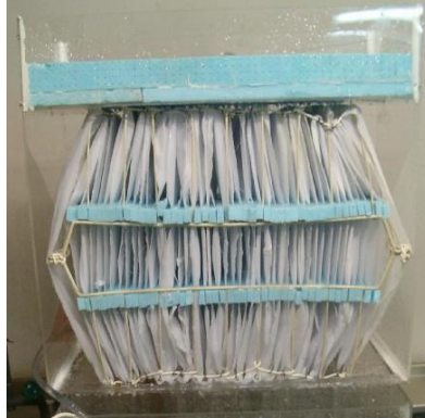
Figura VII.1.2: Vista frontal del sistema evaporativo base
