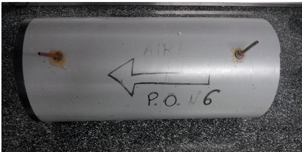
Figura VII.2.11 Placa orificio con sus dos salidas para medición de presión diferencial
