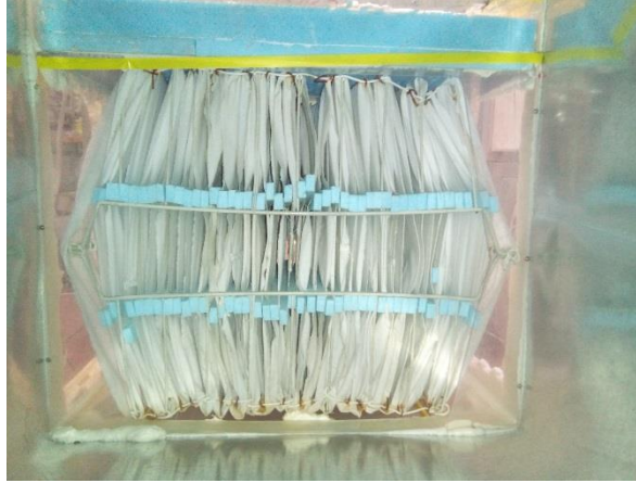
Figura VII.1.3: Vista interior del sistema y detalle de los sellos con espuma.
