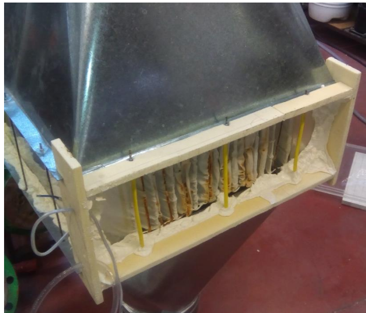
Figura VII.1.4: Detalle del soporte y del sellado.
