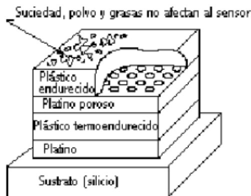
Figura VII.2.8 Esquema de las capas de un sensor de humedad capacitivo.[W-5]
