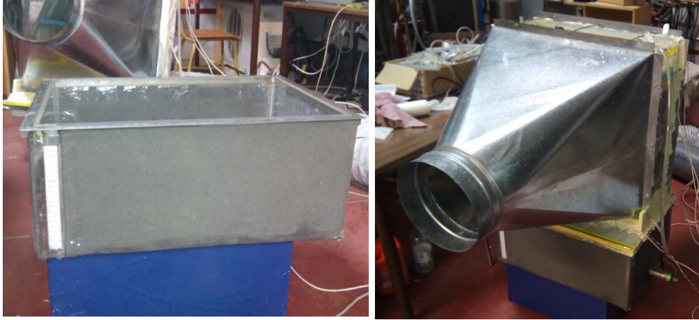
Figura VII.1.6: A la izquierda el tanque cubierto de aislante. A la derecha el dispositivo experimental finalmente acabado.
