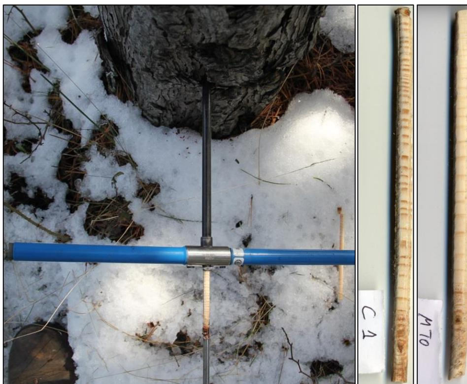
**Figura 7.** Muestreo de la edad en campo con barrena Pressler (izda.) y fase de conteo de anillos de crecimiento en gabinete (dcha.).
