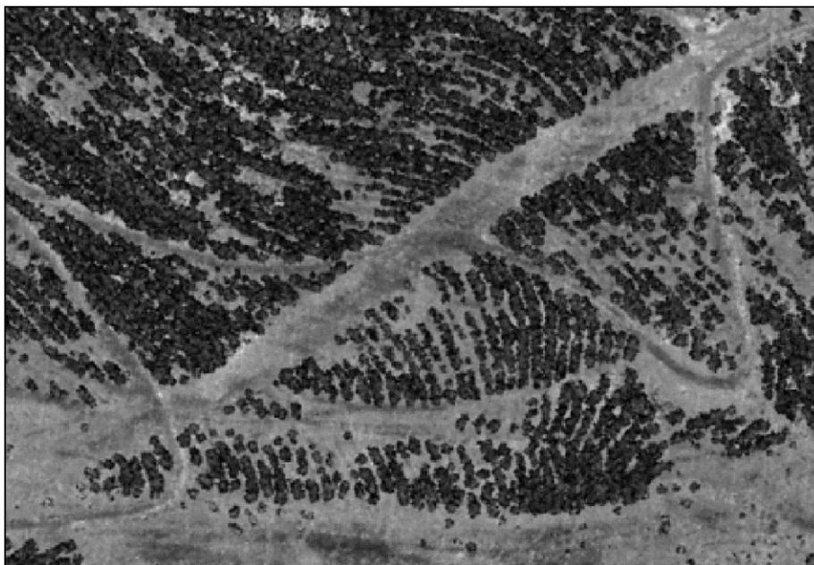
**Figura 11.** Imagen de un mapa de intensidades de retornos LiDAR de una formación de *Pinus nigra* Arn. obtenida con el algoritmo “*IntensityImage*” de Fusion® V3.50 para una nube de puntos del vuelo del Plan Nacional de Ortofotografía Aérea (PNOA) del año 2010 en La Rioja.
