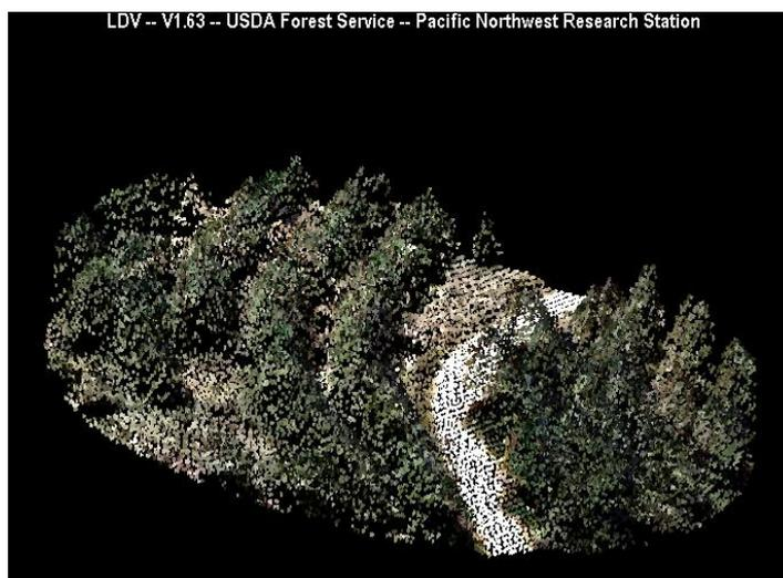
**Figura 4.** Vista 3D en Fusion® V3.50 de nube de puntos LiDAR del vuelo del Plan Nacional de Ortofotografía Aérea (PNOA) del año 2010 en La Rioja coloreada con la información de las ortofotos en RGB.
