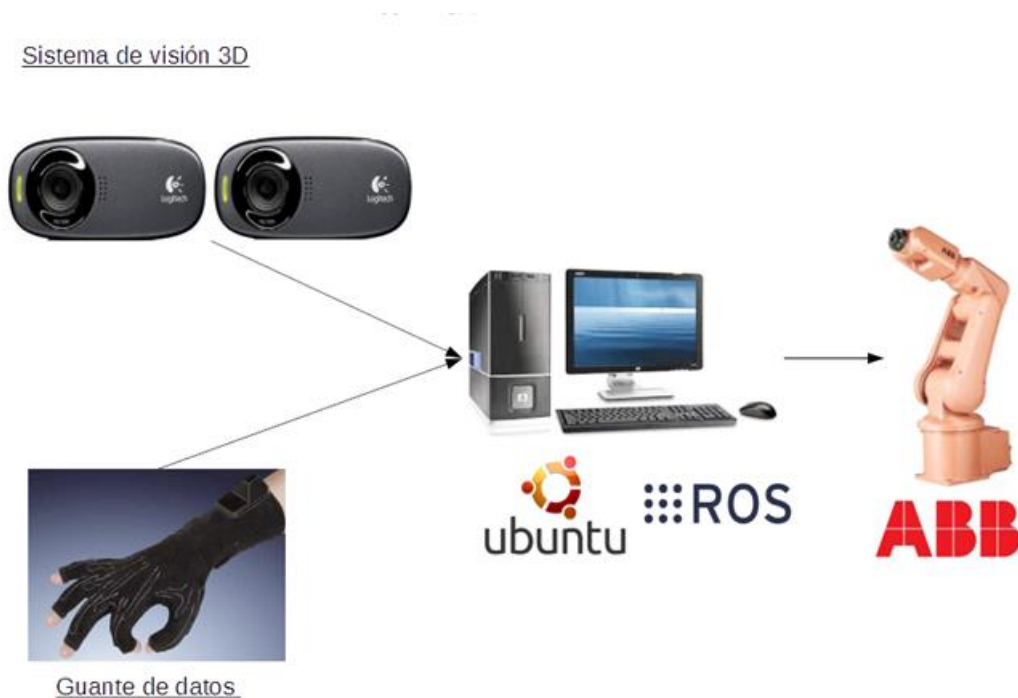
Figura 6 Esquema de componentes de la estación
