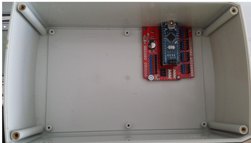
Figura 69: Sujeción de la placa a la base de la caja
