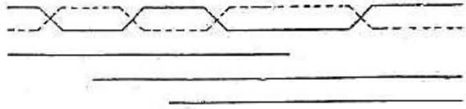
(178) Circuito telefónico protegido contra hilos eléctricos 18 .
