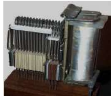
(252) Relé de armadura y contactos 77 .
