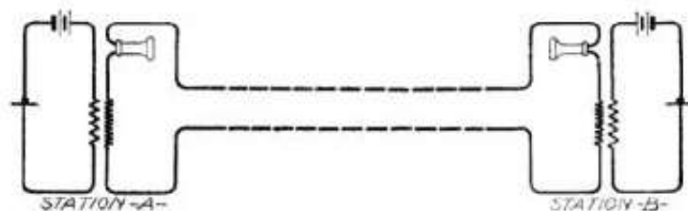
(103) Estaciones micro-telefónicas de batería local conectadas por doble hilo 50 .
