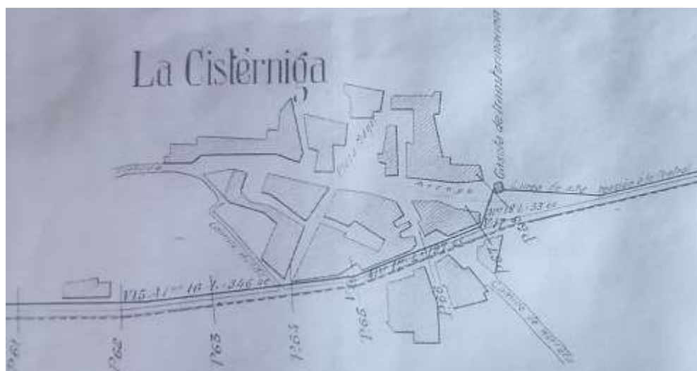
(91) Tramo provincial de la 1ª línea proyectada a su llegada a la subestación de la Cistérniga 22 .
