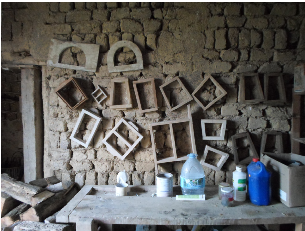
Amayuelas de Arriba (Palencia). Taller de un artesano dedicado al oficio de fabricar adobes. Pueden observarse moldes, mecales y adoberas de muy diferentes formas y tamaños para la fabricación de adobes, destacando el molde para la ejecución de arcos
