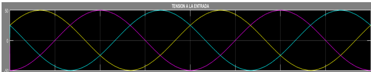
Fig. 8.2. Señal de la tensión a la entrada del rectificador
