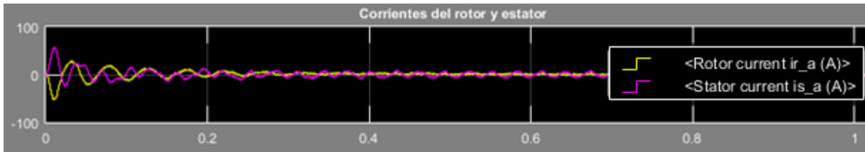
Fig. 8.25. Corrientes en el estator y rotor para una velocidad de 1000 rpm en función del tiempo
