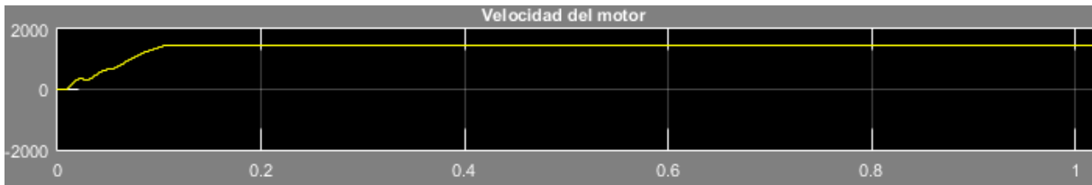
Fig. 8.31. Evolución de la velocidad hasta estabilizarse en 1500 rpm en función del tiempo
