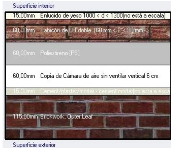
Figura 5: Sección del muro exterior.
