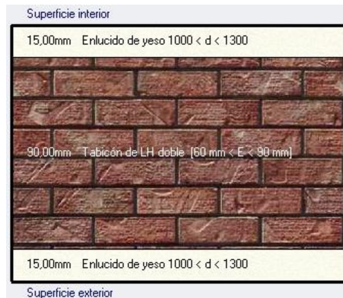
Figura 41: Sección de la plantilla Tabicón.
