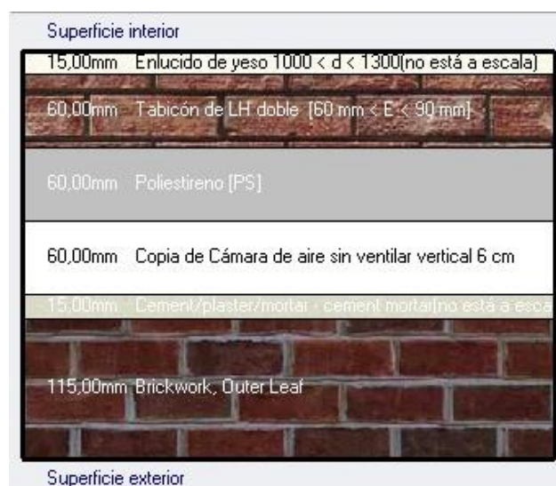
Figura 35: Sección de la plantilla Fachada.
