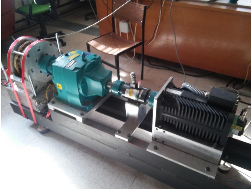
Figura 1: Banco de ensayos utilizado para los ensayos de reluctancia con el motor de arrastre.
