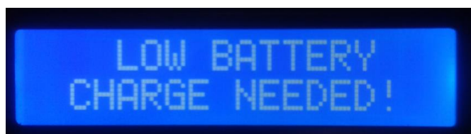
Ilustración 12: Indicación de poner a cargar el aparato.
