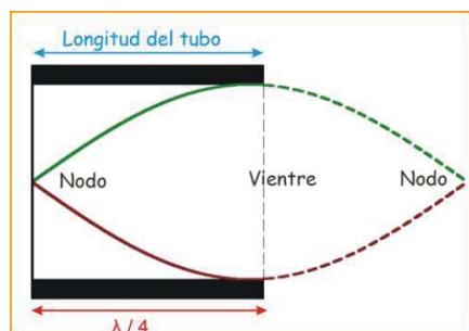
Ilustración 4. Tubo sonoro cerrado. Imagen extraída de www.lpi.tel.uva.es
