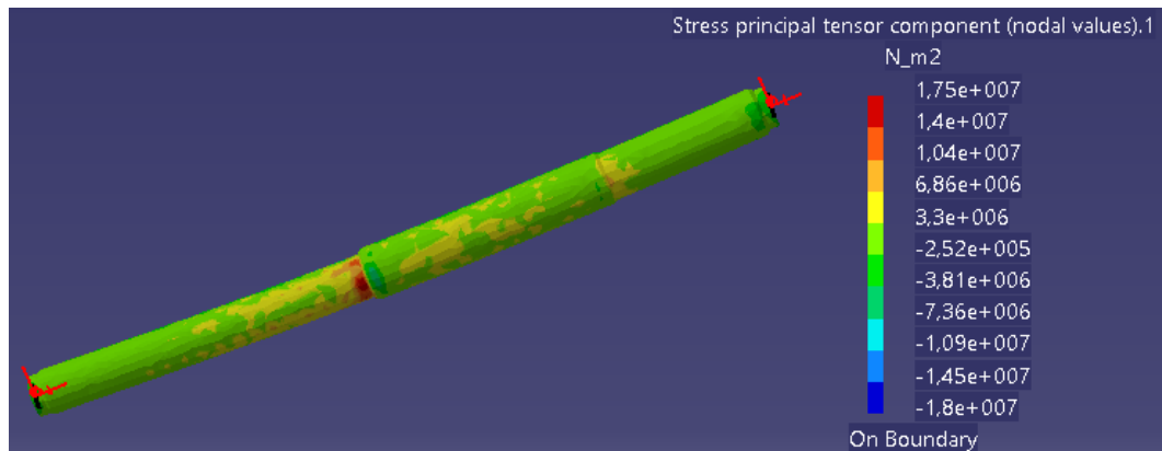
Figura 7.18. Tensión principal \sigma_2 en la parte inferior de la pieza.
