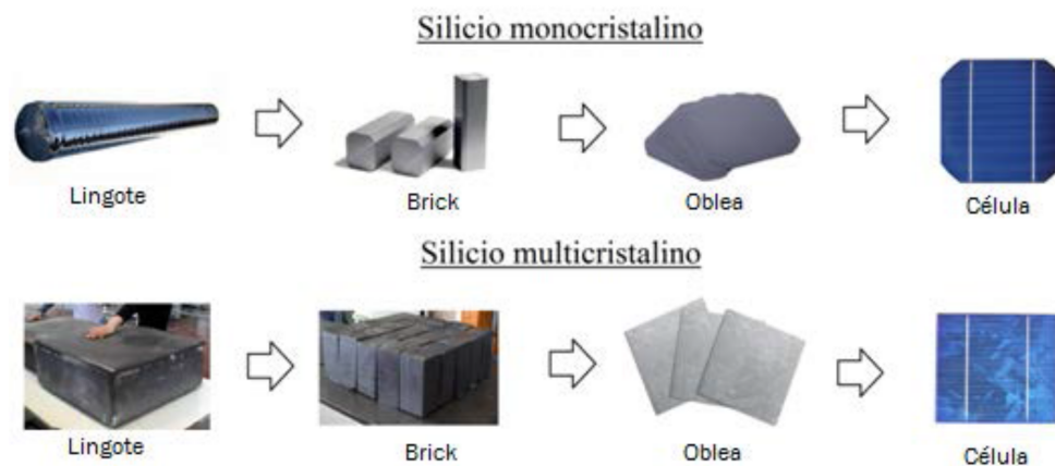
Figura 4.9: Imagen del proceso de fabricación de una célula solar a partir de Silicio monocristalino y de Silicio multicristalino
