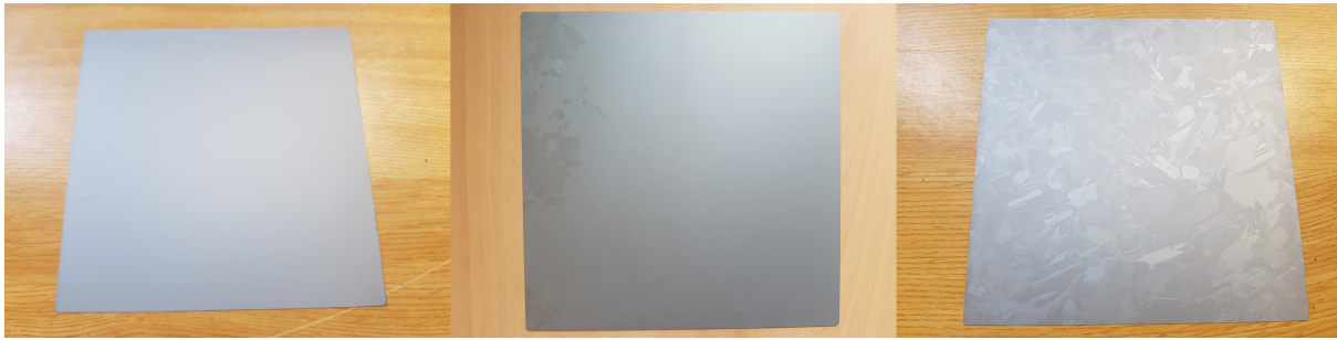
Figura 4.11: Los tres tipos de oblea según su modo de cristalización: a la izquierda monocristalina, en medio cuasi-cristalina y a la derecha multicristalina
