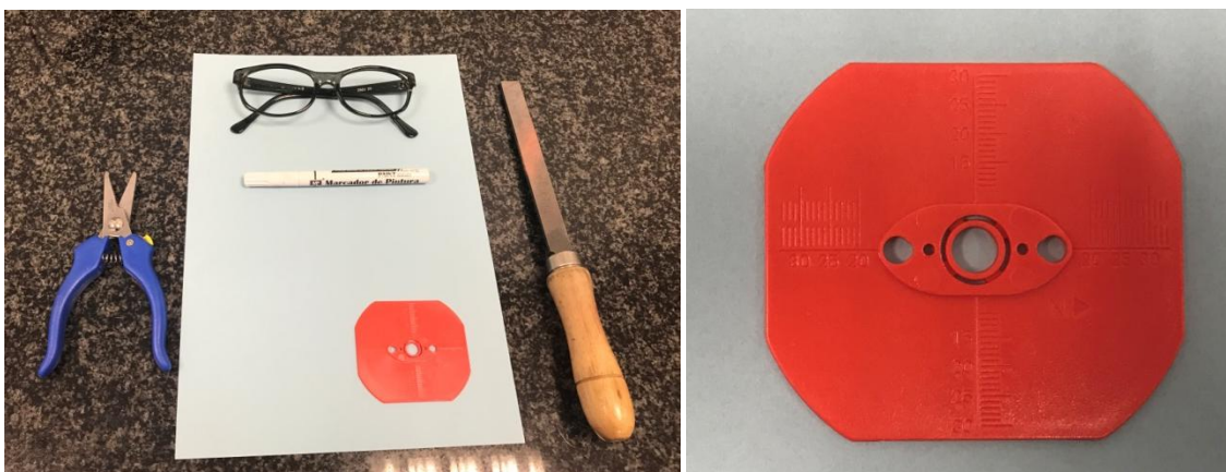
Figura 5. Material necesario para la elaboración y comprobación de la plantilla. Tijeras, plantilla, montura, cartulina, rotulador indeleble y lima. A la derecha imagen de la plantilla en la que se observan las características principales (Videos preliminares)
