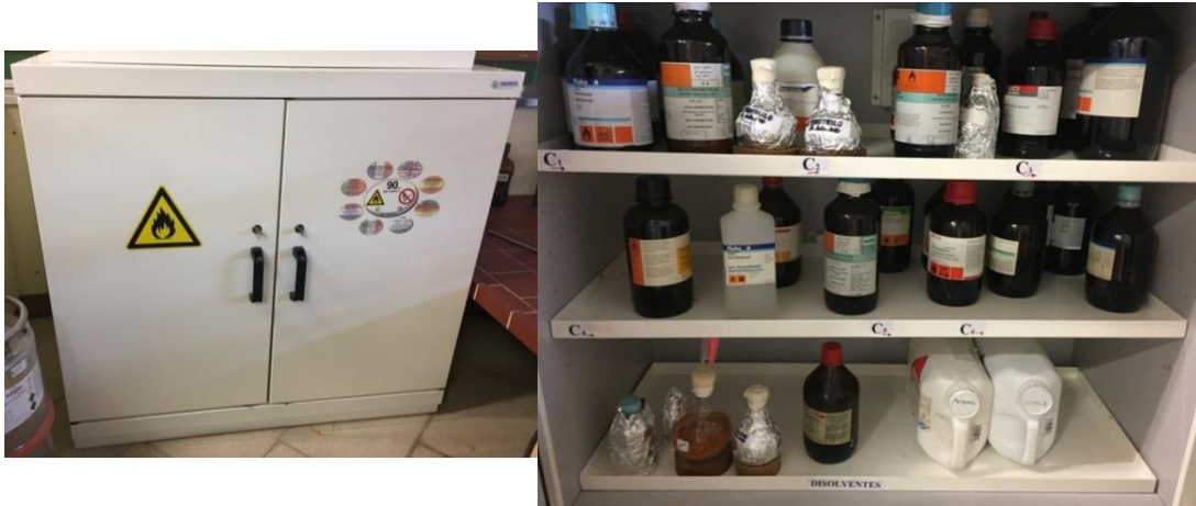
Figura 5.7- Armario de productos inflamables vista exterior e interior.
