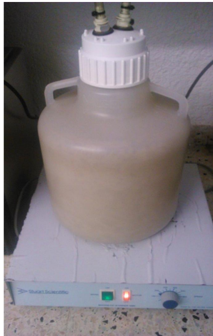
Figura 7. Tanque agitado utilizado en el enriquecimiento de metanótrofos.
