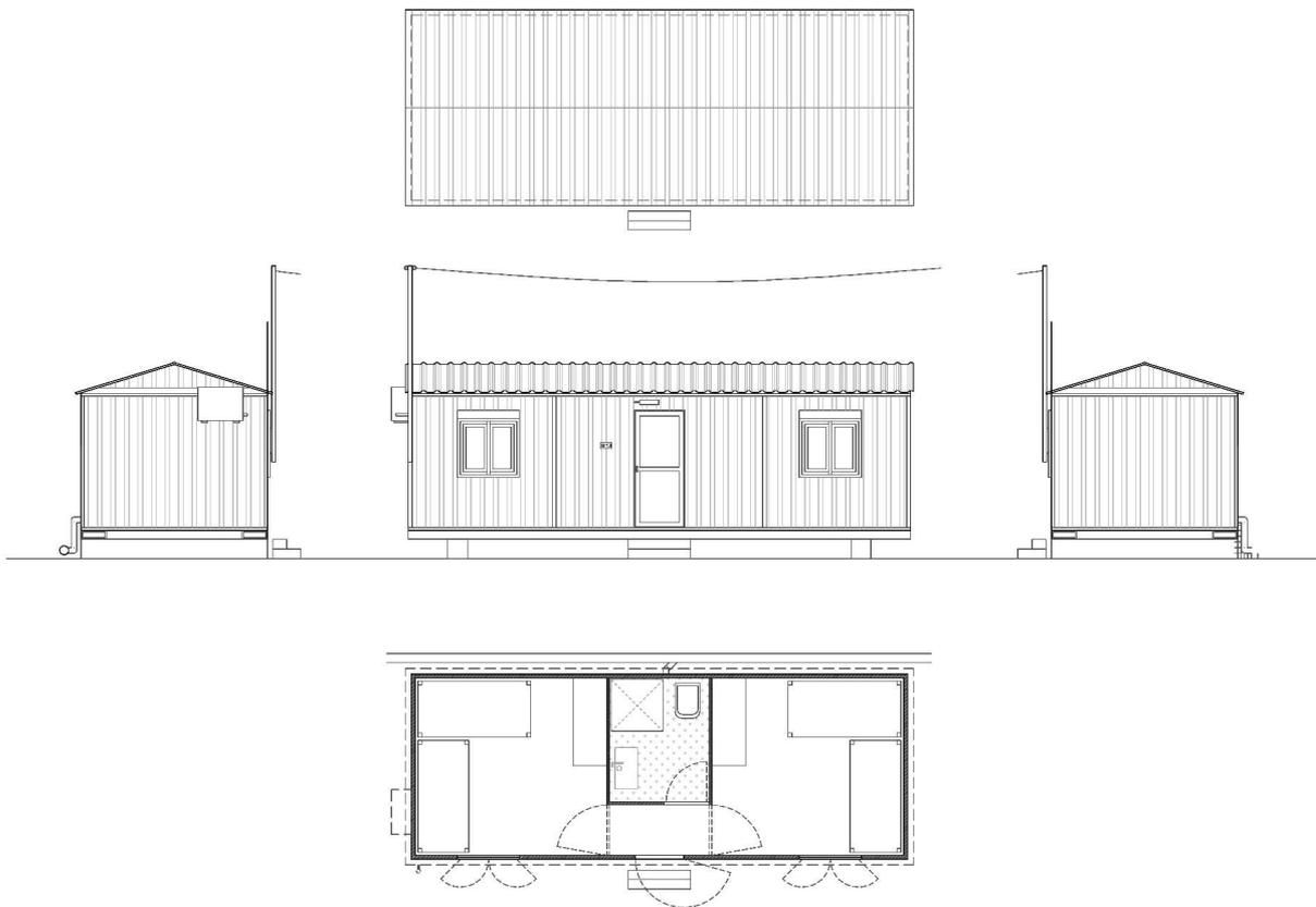
**Fig. nº 21:** Levantamiento de un módulo tipo.
