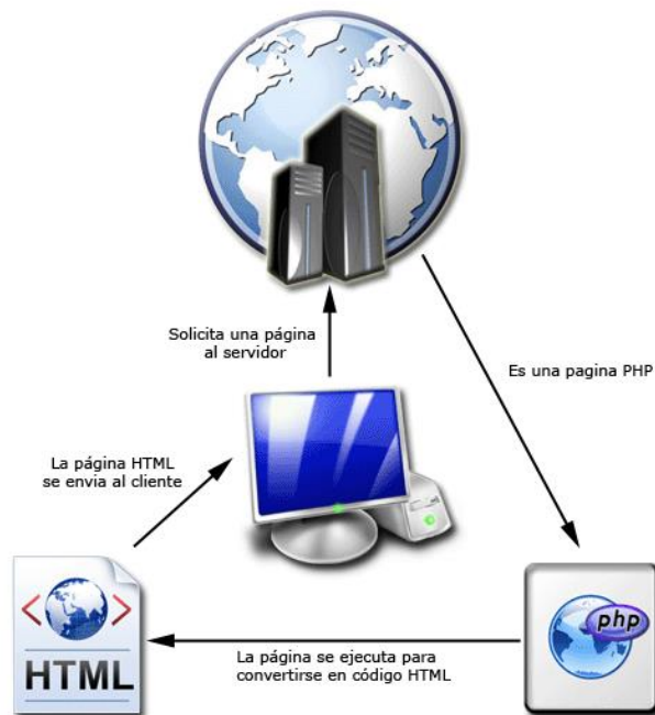
Figura 18 - Esquema básico de funcionamiento de PHP (Herraez, 2015)
