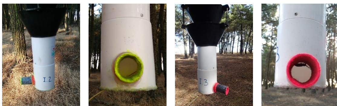
Figura 17. Dispositivo de infección alto (a y b) y detalle de dispositivo de autoliberación un (1,0 cm) centímetro por encima de la malla de fondo. Dispositivo de infección bajo (c y d) y detalle de dispositivo de autoliberación e infección enrasado con la malla inferior del bote colector Econex extended.
