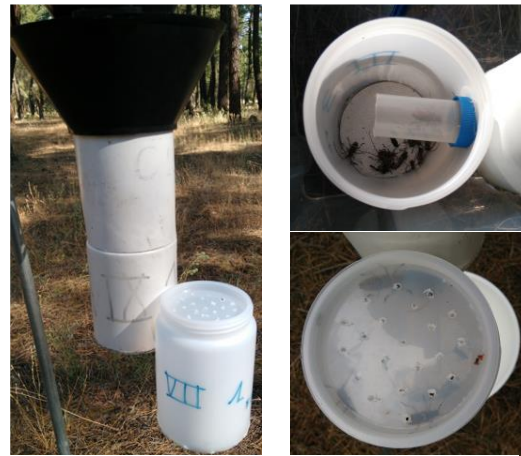
Figura 12. Bote auxiliar unido a prototipo (izq.). Detalle de unión con el prototipo (la tapa azul se emplea de unión entre ambos botes), detalle de dispositivo de autoliberación y detalle de malla tupida en fondo y capturas (Der. arriba). Detalle de tapa perforada en bote auxiliar para permitir la aireación (Der. abajo).
