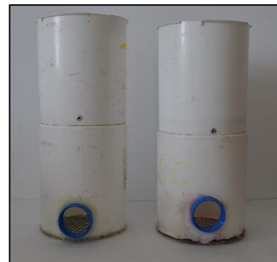
Figura 14. Diferentes alturas del dispositivo de autoliberación. Izq. a ras del fondo (Tubo Bajo). Der. elevado 1,0 cm del fondo (Tubo Alto).
