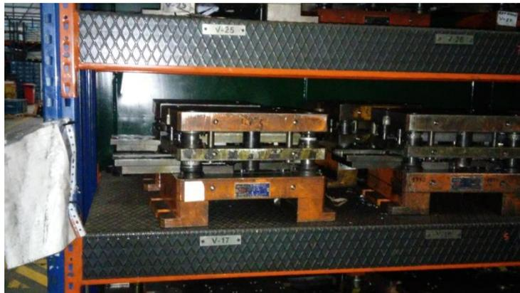
Imagen 3.11: Troquel de corte de la lámina anti ruido. Fuente: Elaboración propia.
