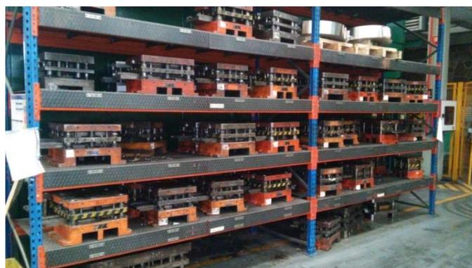
Imagen 3.10: Almacenamiento de troqueles para el corte de la lámina anti ruido. Fuente: Elaboración propia.
