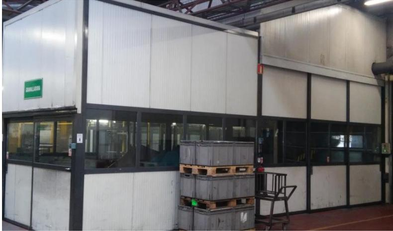
Imagen 3.16: Máquina de granallado de soportes metálicos. Fuente: Elaboración propia.
