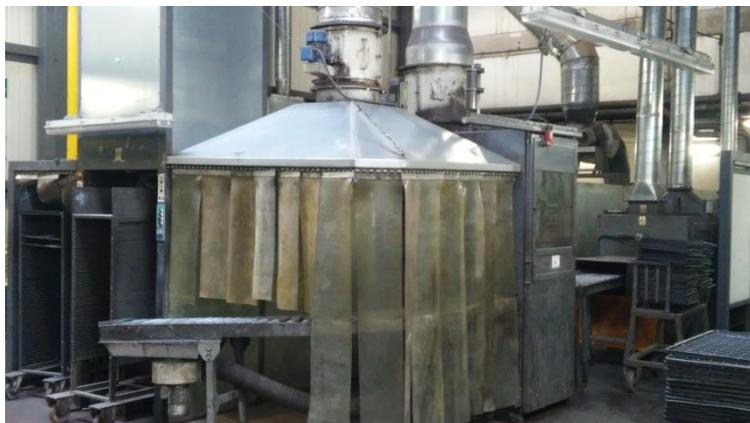
Imagen 3.18: Cabina de aplicación de pegamento en polvo. Fuente: Elaboración propia.
