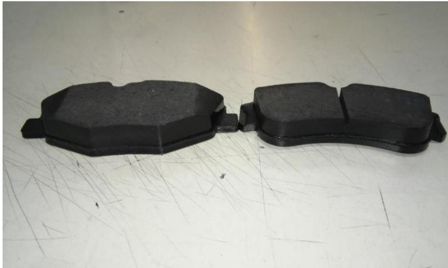
Imagen 2.7: Foto de pastillas que acaban de ser mecanizada. Fuente: Elaboración propia.
