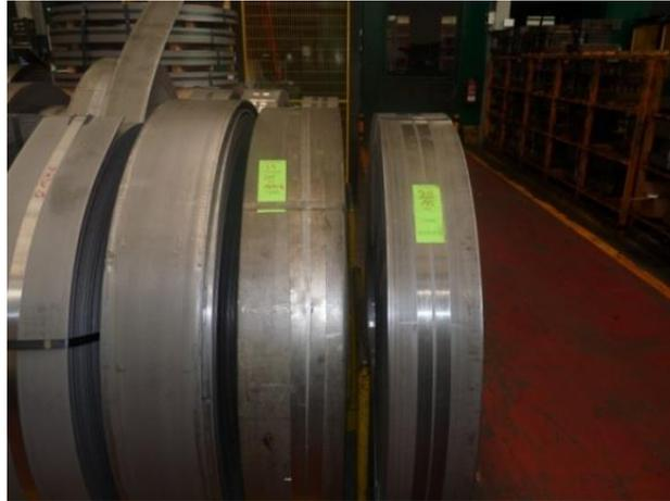
Imagen 3.4: Distintas anchuras en las bobinas de acero. Fuente: Elaboración propia.
