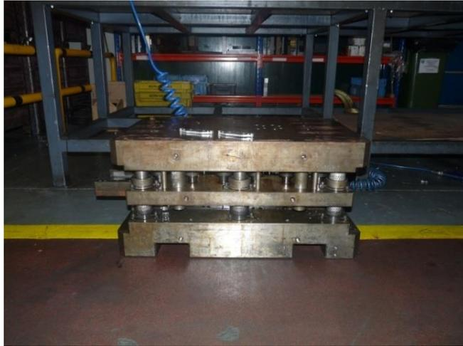
Imagen 3.3: Troquel de corte de soportes metálicos. Fuente: Elaboración propia.
