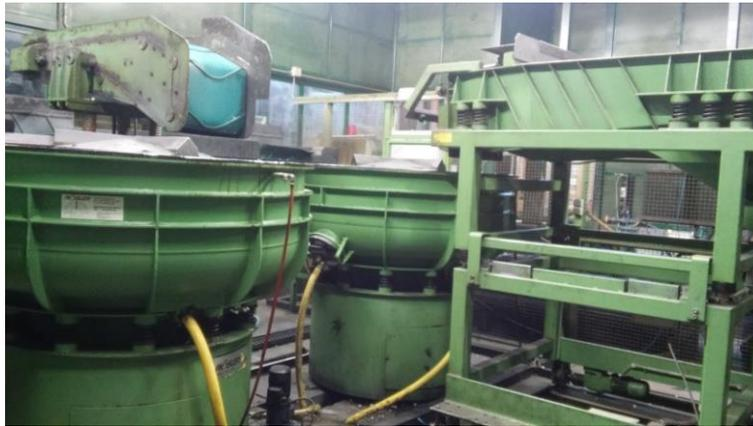
Imagen 3.8: Cubas de vibrado de soportes metálicos. Fuente: Elaboración propia.
