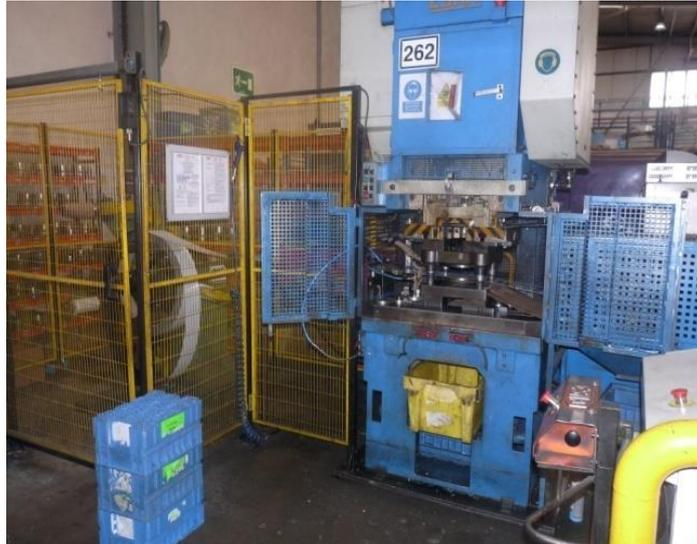
Imagen 3.13: Prensa de corte de láminas anti ruido. Fuente: Elaboración propia.
