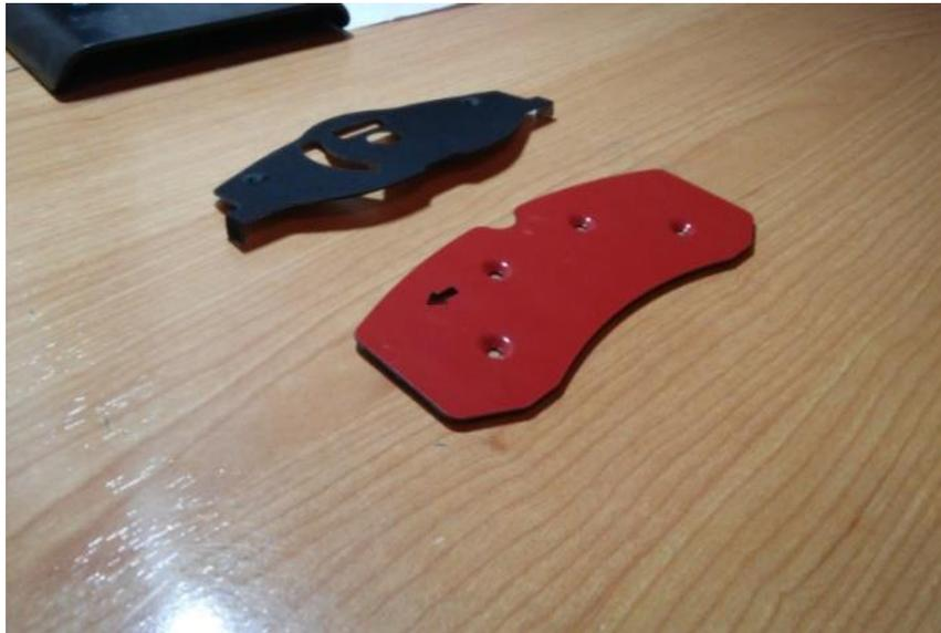
Imagen 2.3: Foto de láminas anti ruido de distintos materiales. Fuente: Elaboración propia.
