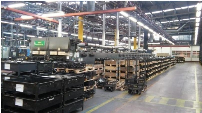
Imagen 3.22: Horno de curado de pastillas. Fuente: Elaboración propia.
