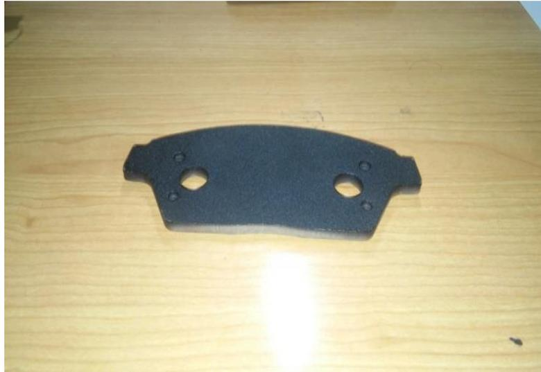
Imagen 2.4: Foto del soporte metálico con el pegamento en polvo. Fuente: Elaboración propia.
