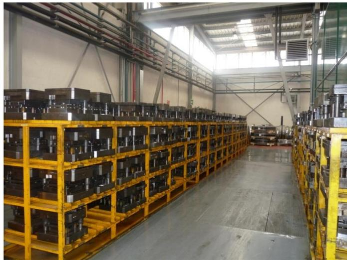
Imagen 3.2: Almacenamiento de troqueles para el corte del soporte metálico.
