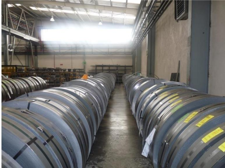
Imagen 3.1: Almacenamiento de bobinas de acero. Fuente: Elaboración propia.
