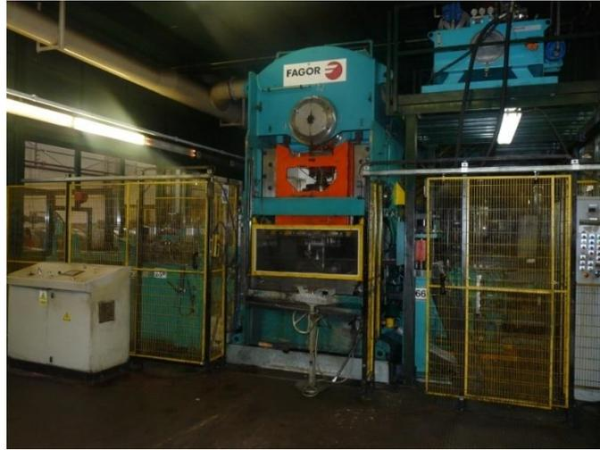
Imagen 3.5: Prensa de corte de soportes metálicos. Fuente: Elaboración propia.
