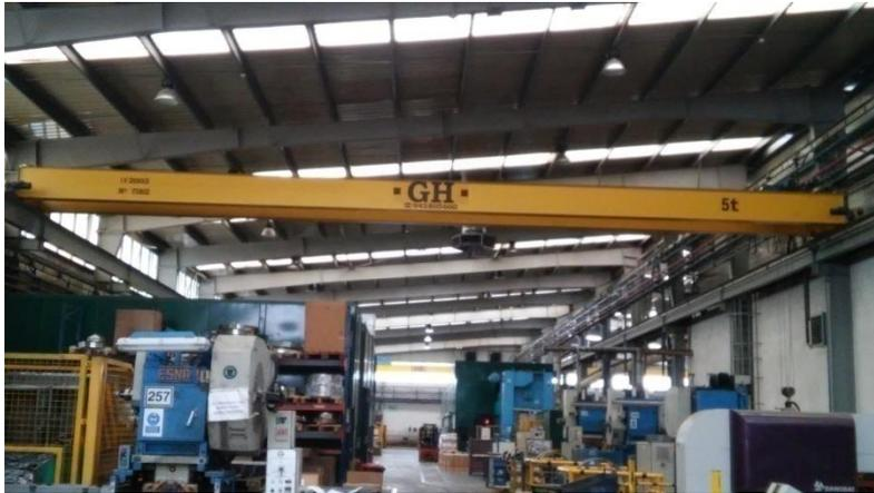
Imagen 3.14: Puente grúa utilizado en la operación de corte de las láminas anti ruido. Fuente: Elaboración propia.
