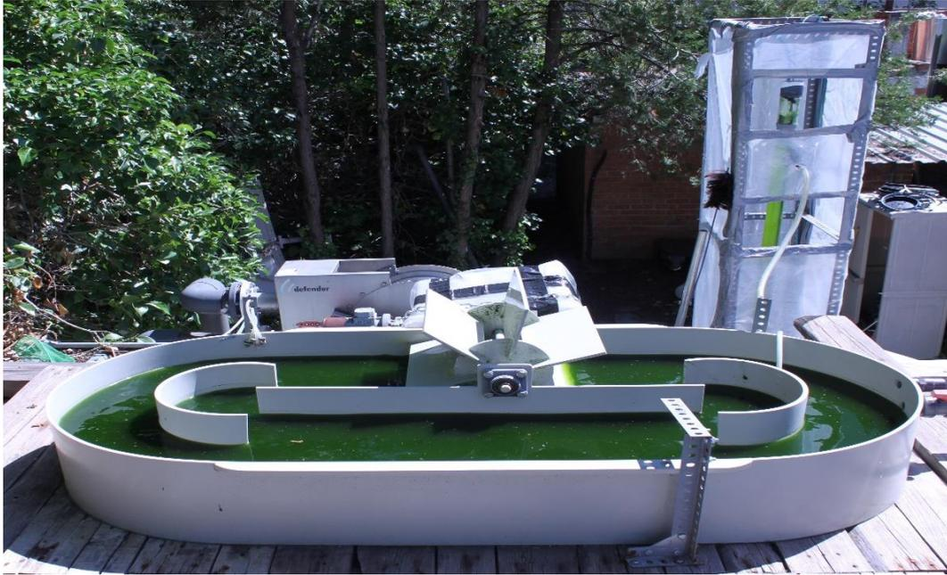
*Figura 5. Fotografía del montaje en el que se incluye el HRAP y las paletas de agitación*
