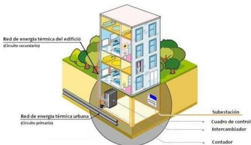
Imagen 23. Subestación en el sótano de un edificio. Fuente ICESA.
