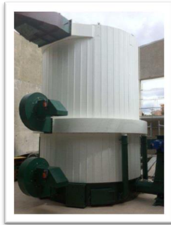
Imagen 48. Sistema de insuflación de aire.
