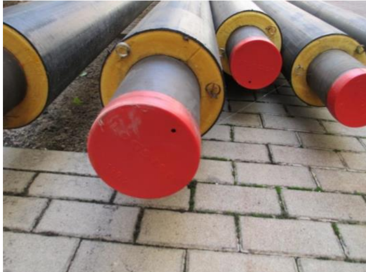
Imagen 55. Tubería de acero pre-aislada portadora de agua.
