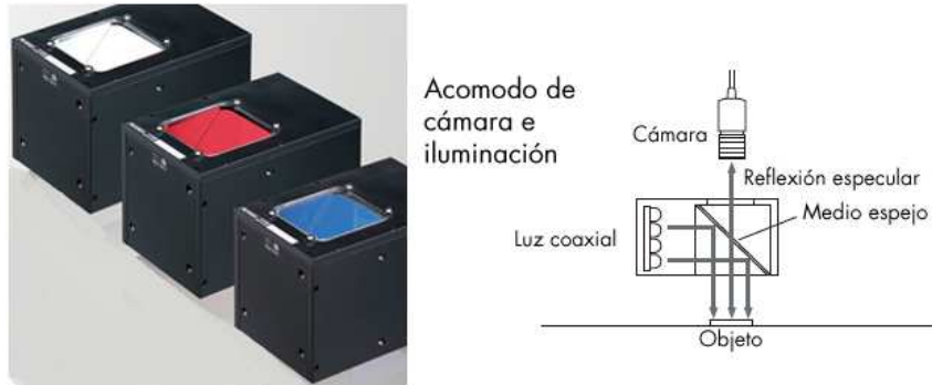
Figura 26. Funcionamiento de Iluminación Coaxial [XG-X Catalogue, 2017].
