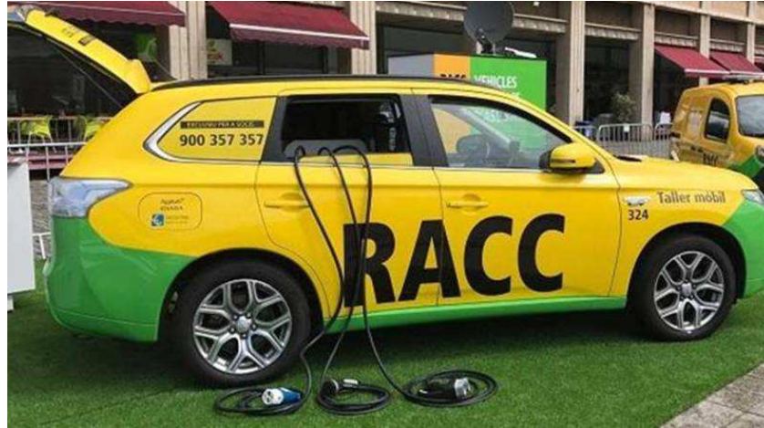
Figura 38. Ejemplo de estación móvil [ http://electromovilidad.net/estacion-de-recarga-movil-del-racc-con-tecnologia-circontrol/ ].
