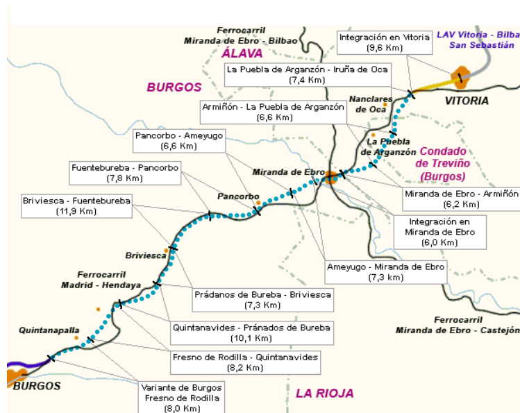
Imagen 1.1 - Plano de proyecto informativo (línea azul de puntos) de la línea Madrid – País Vasco – Francia, correspondiente al tramo entre Burgos y Vitoria.
