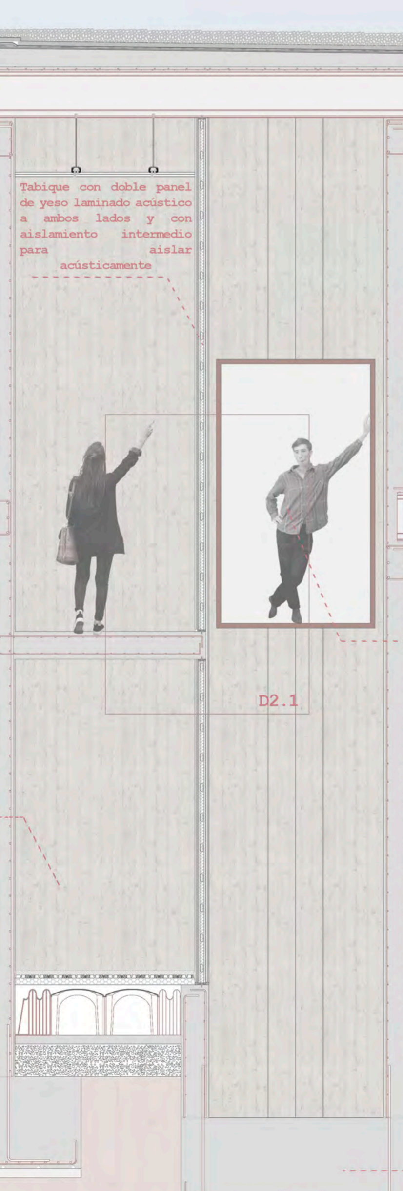
Falso techo suspendido de laminas de madera DM recubierta a cara vista de madera natural barnizada para exteriores y colgado de las losas alveolares mediante perfilera galvanizada
