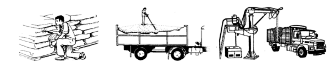
Figura 64: Clasificación de las rutinas de la materia prima por descargada a granel, 1- Descarga de productos en sacos, 2-Descarga a granel de gránulos de tamaño <10 mm con sonda manual. 3-Descarga a granel de gránulos de tamaño <10 mm automáticamente. (F. FAO)
