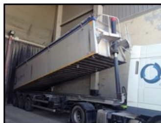
Figura 24: Descarga automática del camión.
