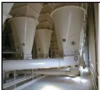
Figura 34: Dosificación de las materias primas y correctores, del proceso de fabricación de piensos compuestos.
