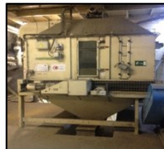
Figura 54: Enfriador de contracorriente usado en la fase de enfriado-secado de los gránulos.
