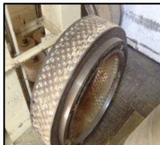
Figura 53: Matriz de granulación de la fase de compresión-extrusión de la harina en la prensa granuladora.
