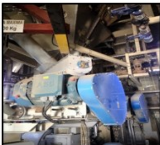
Figura 52: Mecanismos de acondicionamiento hidrotérmico de la harina procedente de la mezcladora.
