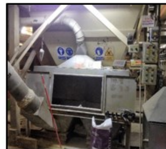
Figura 34: Dosificación de las materias primas y correctores, del proceso de fabricación de piensos compuestos.
