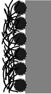
Ilustración 8: Estructura simplificada de un electrodo (J. Larminie and A. Dicks 2003)
