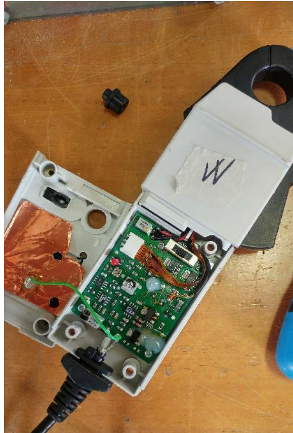
Ilustración 6: Circuito integrado de una sonda de corriente.
