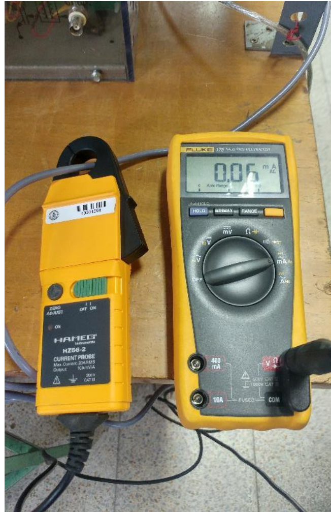
Ilustración 7: Comprobación del funcionamiento de la sonda de corriente.
