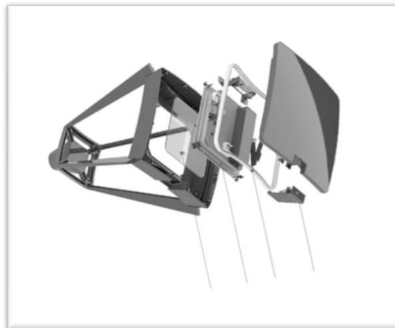
Figura 4.3. Luminaria Córdoba desmontada.
