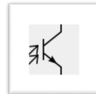
Figura 5.6. Representación con su símbolo eléctrico de un fototransistor.
