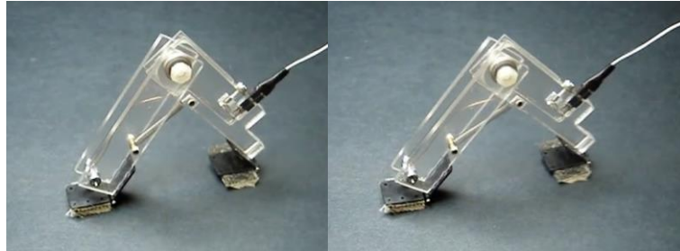
Figura IV-5. Inchworm robot realizado con nitinol. (a) Nitinol contraído. (b) Nitinol relajado y muelle ejerciendo esfuerzo de recuperación
