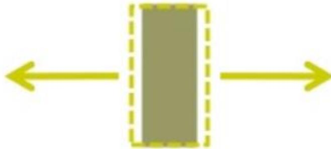
Figura 41. Diagrama del esfuerzo axial sobre una sección, con el criterio de signos positivo. Fuente: <https://es.slideshare.net/maribelcastilla/bloque-a-teora-de-representacin-de-diagramas-de-esfuerzos-mecnica-de-slidos-grupo-4-1213>
