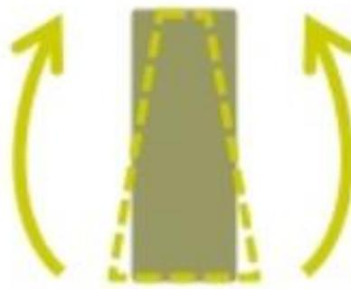
Figura 42. Diagrama del momento flector sobre una sección, con el criterio de signos positivo. Fuente:
