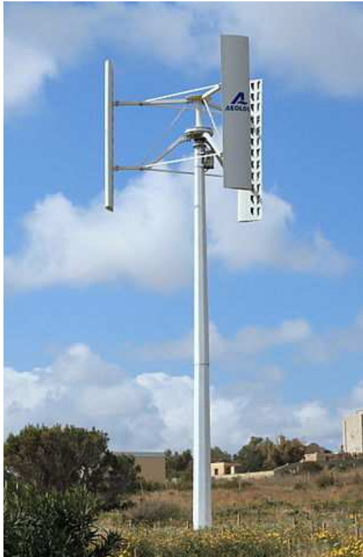
Figura 1.6: Aerogenerador VAWT H-Darrieus. Fuente: Wikimedia Commons.
