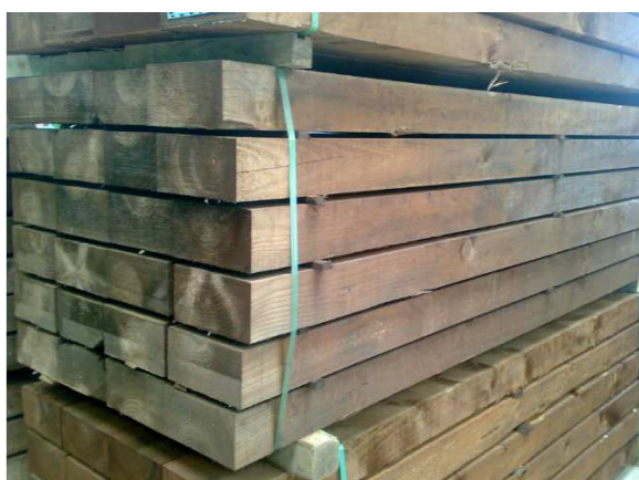
Ilustración 100. Traviesas de madera tratada. (Fuente: https://www.maderasaguirre.com ).
