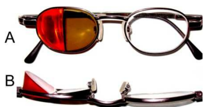
Figura 10: Gafas de prisma Trifield. En la imagen (A) Vista frontal. (B) Vista desde arriba. Los prismas tintados ayudan a determinar la dirección verídica de los objetos que se ven a través de ellos (43) .
