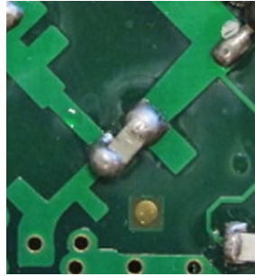
Figura 5.5: Componentes del divisor de potencia del módulo de radar HB-100 [XIV]
