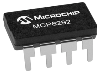
(a) Microchip de amplificador operacional doble [VII]
