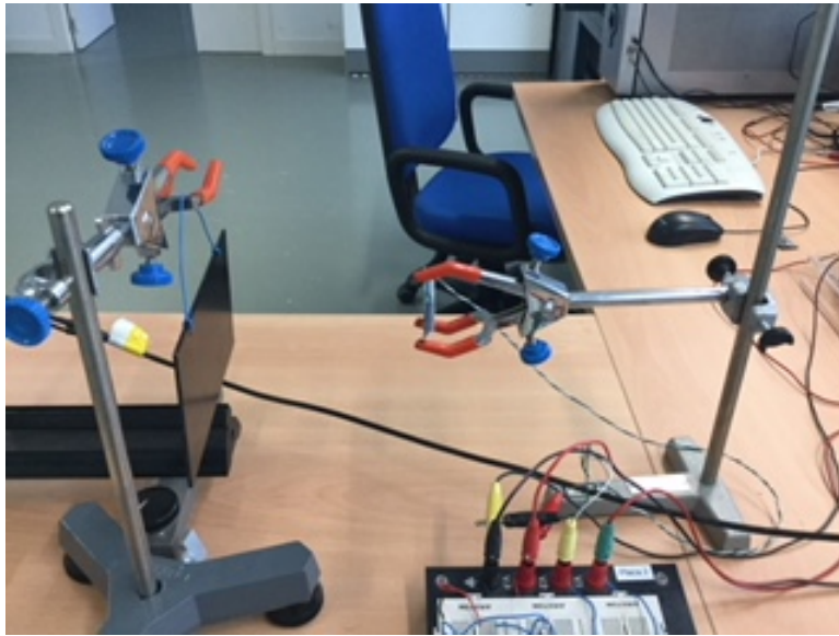
Figura 3.13: Montaje experimental definitivo con placa problema
