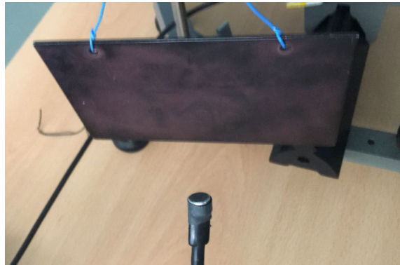
Figure 2.3: Dispositivo experimental para la determinación de los modos de vibración con micrófono
