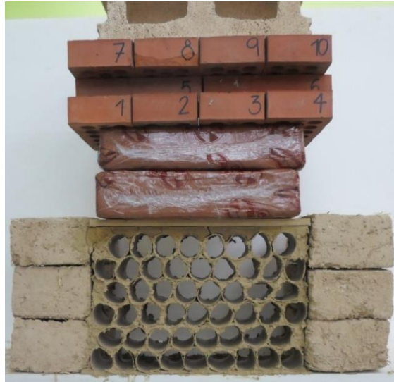
Ilustración 81. Muro de WCM con 54,6 kg de carga. Fuente. Elaboración propia.
