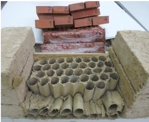
Ilustración 82 y 83. Muro de WCM con rotura y desplome después de acción de 62,40 kg. Fuente. Elaboración propia.
