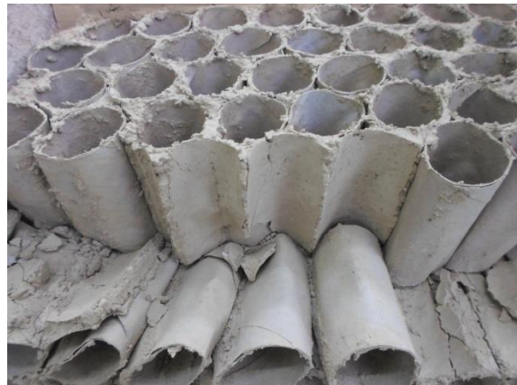
Ilustración 82 y 83. Muro de WCM con rotura y desplome después de acción de 62,40 kg. Fuente. Elaboración propia.
