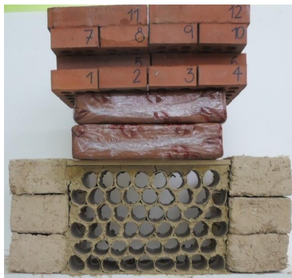
Ilustración 80. Muro de WCM con 45 kg de carga. Fuente. Elaboración propia.
