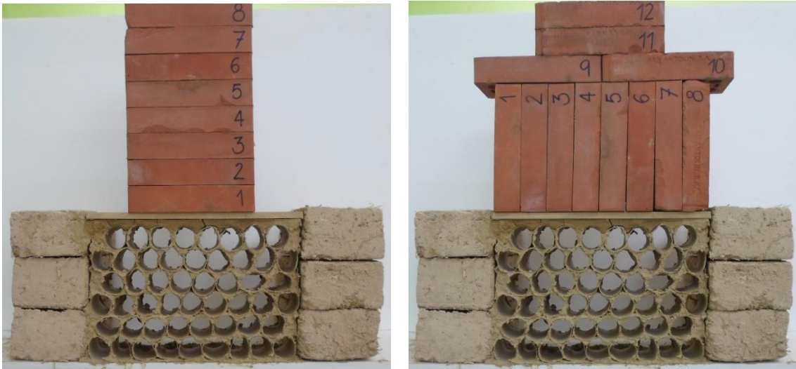
Ilustración 78 y 79. Muro de WCM con 20 kg de carga. Fuente. Elaboración propia.
