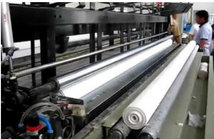
Ilustración 48. Máquina corte conjunto papel higiénico. Fuente. https://www.youtube.com/watch?v=YqIFmI7ZA
