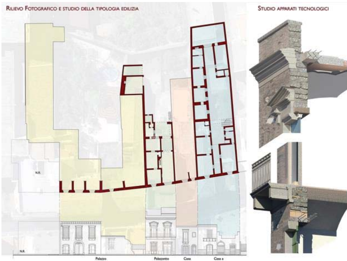
Figura 6. Via Roma, San Giovanni La Punta: analisi tipologica delle unità edilizie e sezione assonometrica costruttiva. (Gruppo Barbagallo, Chiarenza, Nigro, Risiglione, Siragusa).
