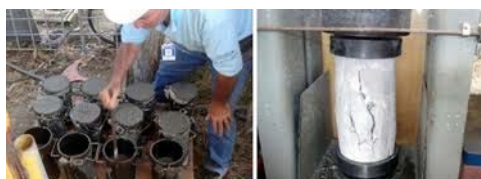
Probetas hormigón: resistencia mecánica a compresión
