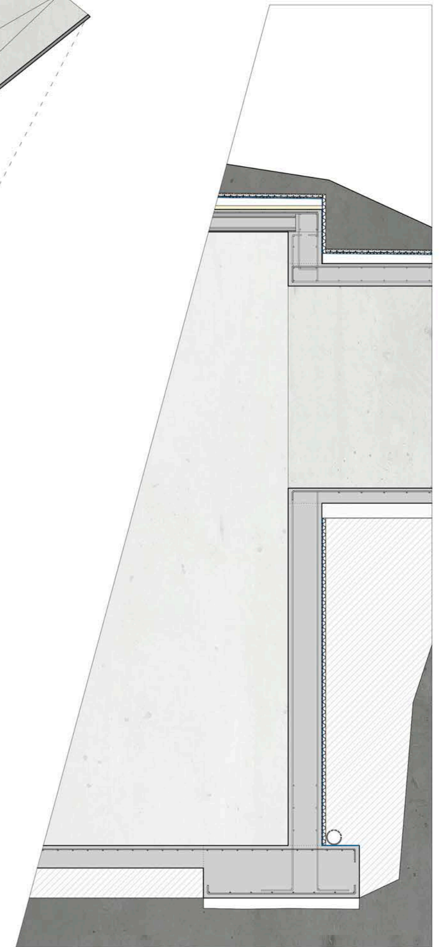
D1 ENCUENTRO DEL FOSO DE MONTACARGAS CON LA CIMENTACION
