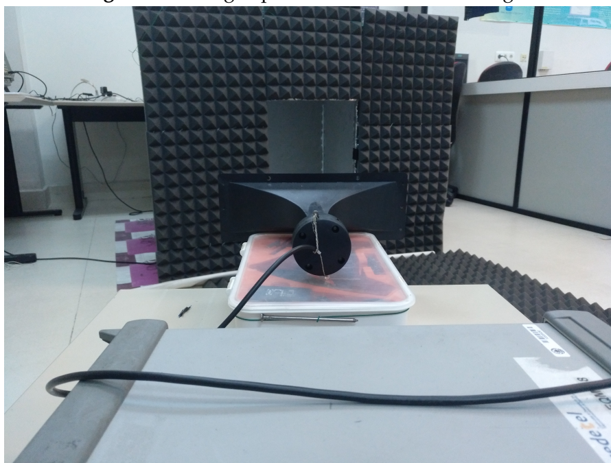
Figura 2.2.: Imagen del sistema de apuntamiento del emisor antiguo
