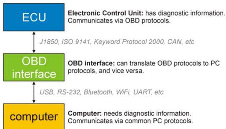
**Figura 5: Esquema de conexión OBD**
