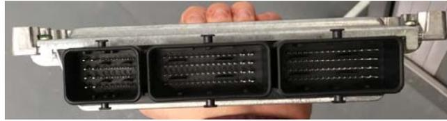
**Figura 2: Conectores de una ECU**
