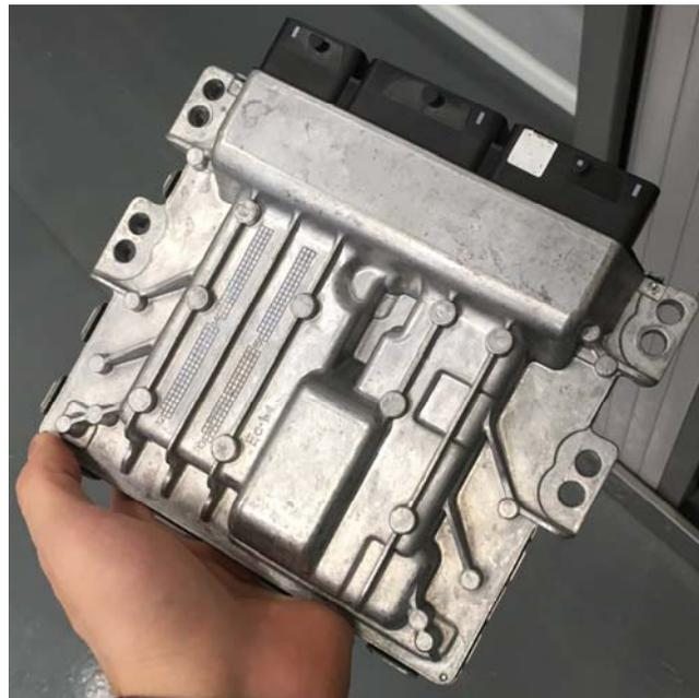
**Figura 1: Exterior de una ECU**
