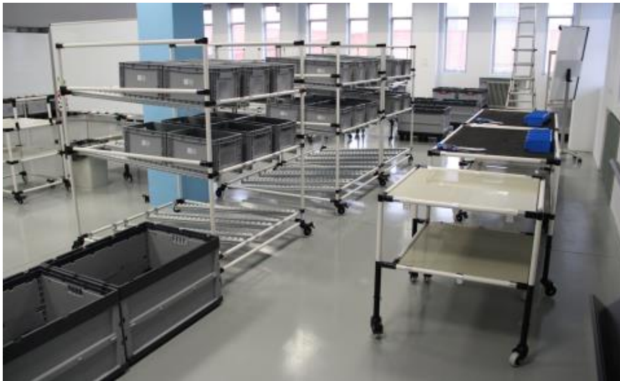
Ilustración 4.5: Puestos de montaje 2 y 3.
