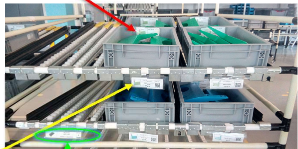
Etiqueta que indica el carril por el que se evacúan las cajas vacías
