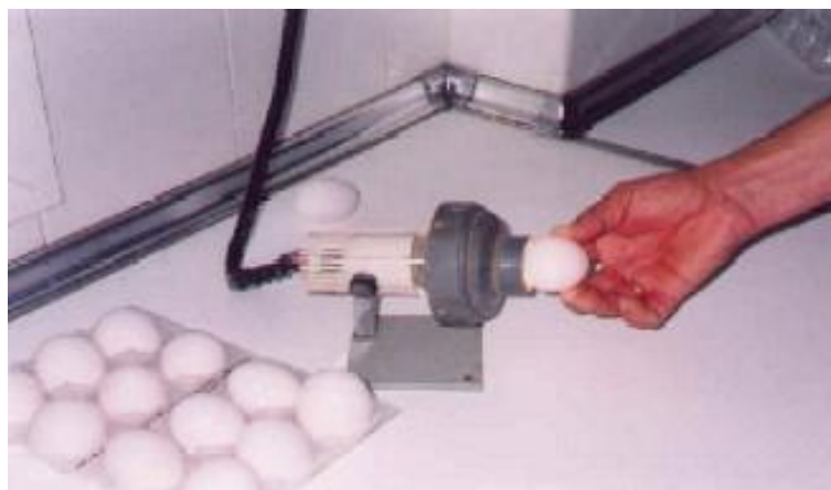
Imagen 1. Ejemplo de cámara de miraje, donde se observan imperfecciones en uno de los huevos (Calidad Agroambiental, S.L.).
