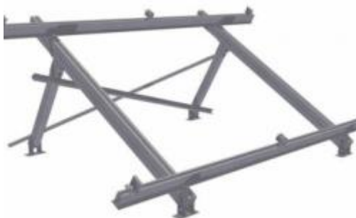
Imagen 2. Estructura para la colocación de los paneles solares.
